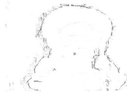
図 2.14: 検出された物体輪郭線 ( \sigma_d : 低域 3.0, 中域 1.5, 高域 0.75, \sigma_{\perp} : 6.0)
