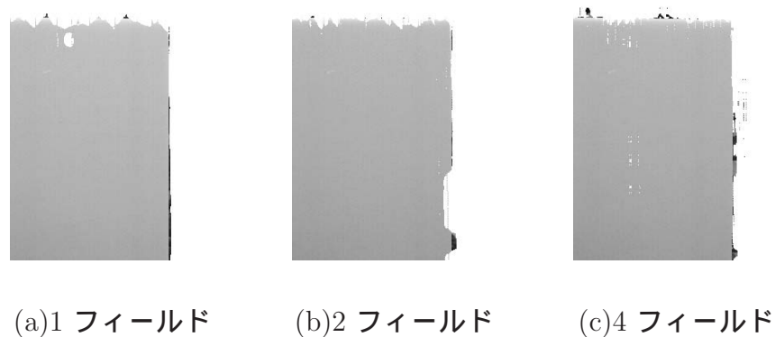
図 3.18: RGB の情報を用いず補間した距離データにより切り出した前景
