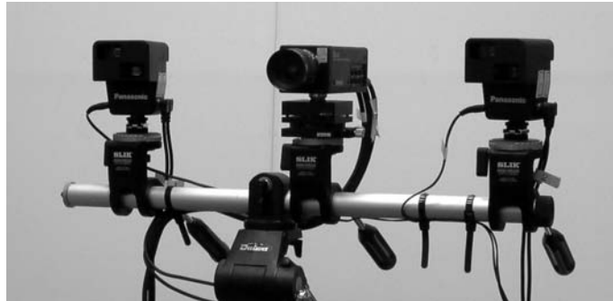
図 5.16: 光源を2セット化したヘッド部
