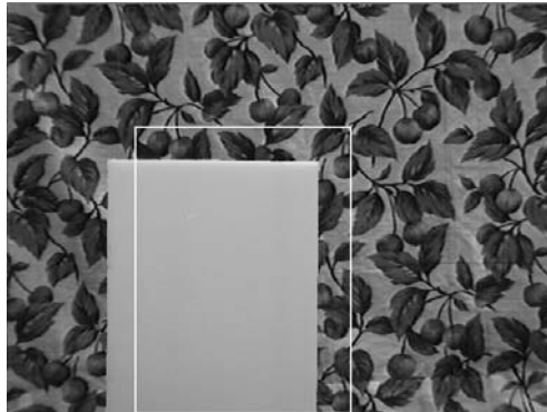
図 3.17: 形状既知の被写体（幅 225mm の矩形板）
