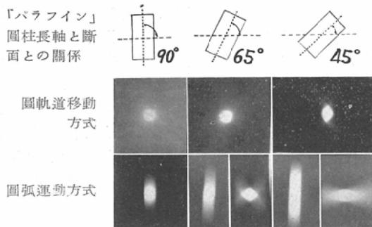
む垂直面がX線管球の運動軌跡を含む垂直面と直交する場合、圓柱の断面に對する傾斜角65度の時には断面像が $1.1 \times 1.6\text{cm}$ のレンズ型となり、傾斜角45度の場合には断面像は $1.1 \times 3.3\text{cm}$ のレンズ型
