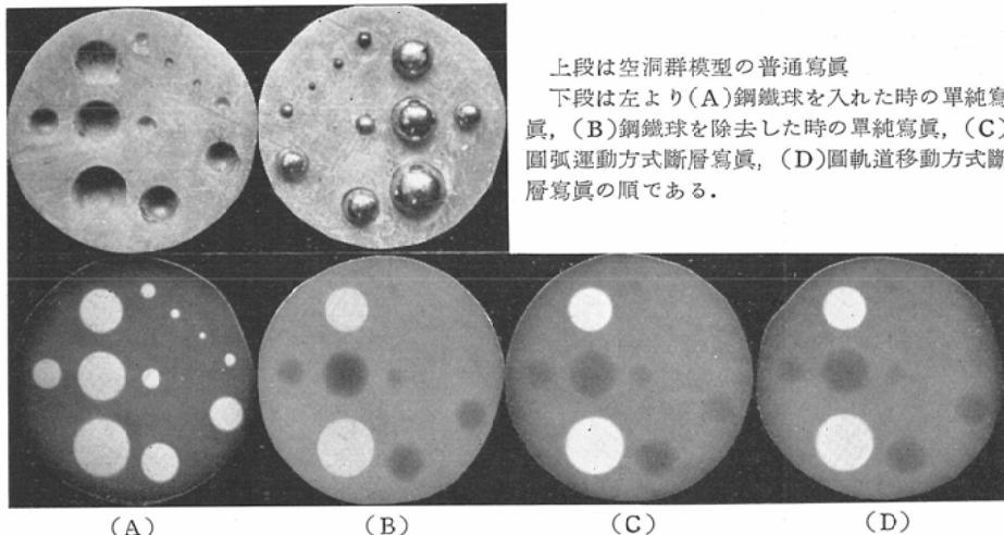
個の鋼鐵球が暈像を伴わない圓形陰影として夫々正確に撮影されて居る事を確めて後、蜜蠟圓盤を上下に均分し、注意深く鋼鐵球を除去した後、再び蜜蠟圓盤を合せた。此の際、余等は蜜蠟圓盤の再現を正確にする爲に 19.05mm 径及び 14.30mm 径の鋼鐵球を除去しなかつた。次いで再び先に求めた断面で圓軌道移動方式断層撮影を行つた。その撮影條件は 50KV、15mA、360 度廻轉であつた。出来上つた寫眞を見ると、15.88mm 径の空洞から 3.98mm 径迄の空洞は現出されて居る。しかし 2.57mm 径の空洞を現出しえなかつた。然るに鋼鐵球
