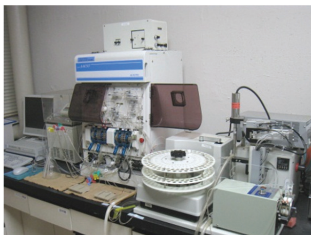
図-3.3 栄養塩分析装置 AACS V
