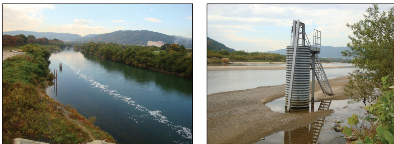
図-4.30 テレメータ観測値が河川の代表水質を表していないと考えられる例 (左：宇治川御幸橋下流側，右：木津川御幸橋上流側)
