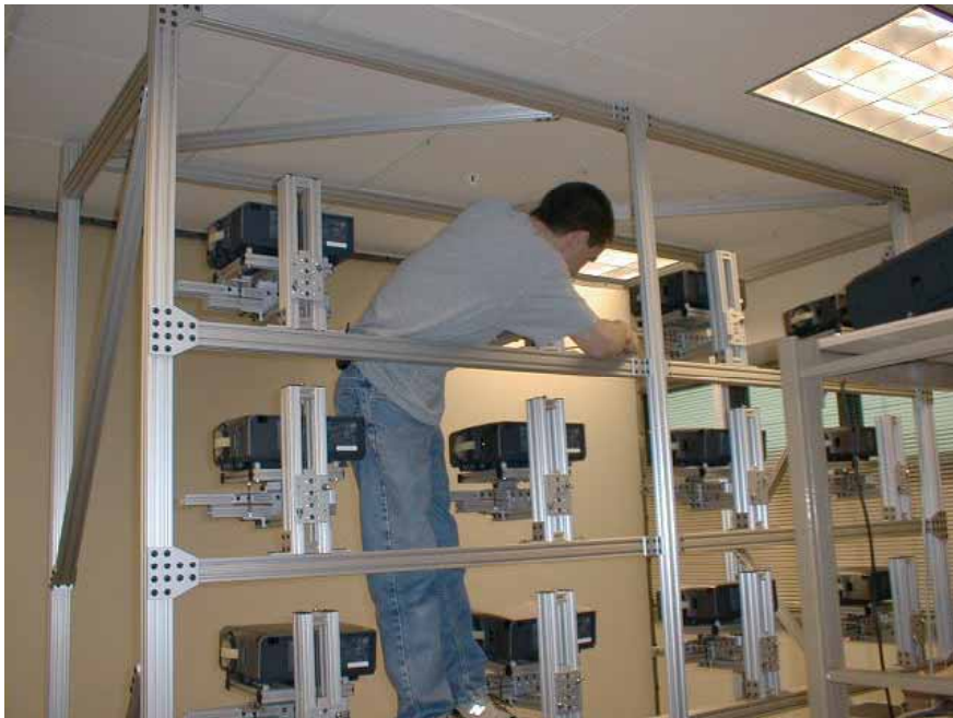
図 2.18 複数プロジェクタの設置調整作業の様子[40].
