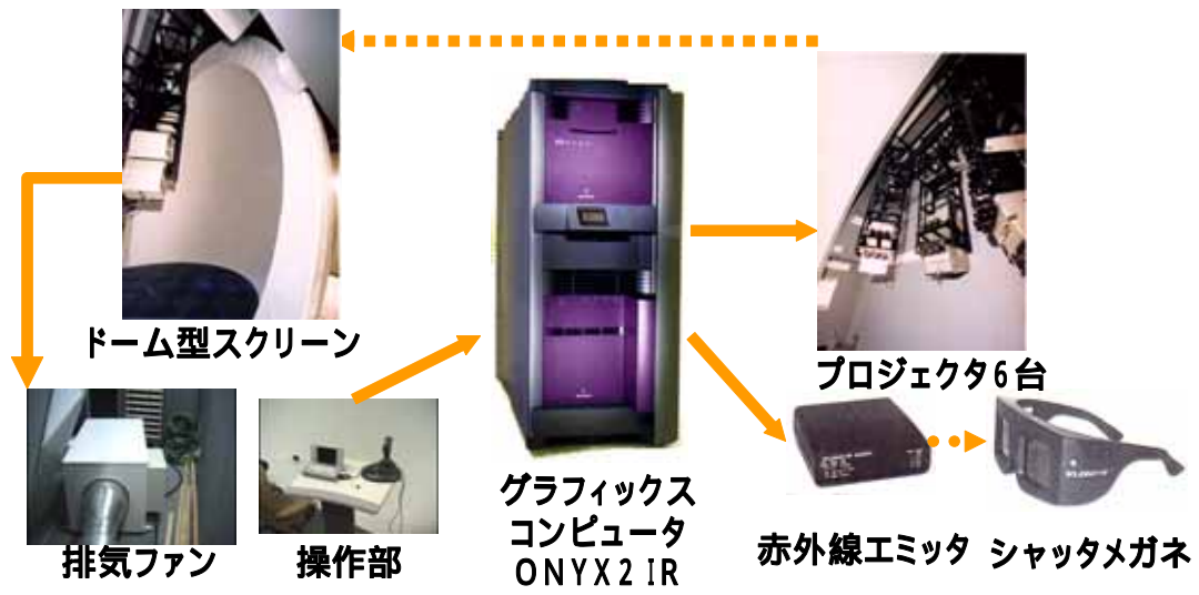
図 3.3 ドーム形状没入型視覚ディスプレイシステム構成図。
