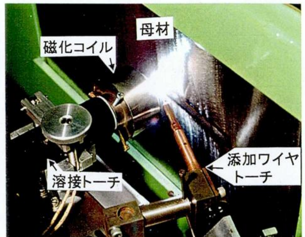
図 4-4 磁気制御 TIG 溶接トーチの外観と溶接状況
