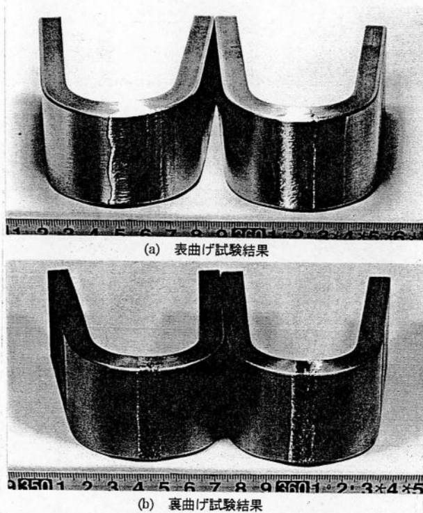
図 5-19 2ワケ式溶融池磁気制御 TIG 溶接部の曲げ試験結果 (母材: ステンレスカット, 板厚: 12.5mm, 溶接姿勢: 横向)
