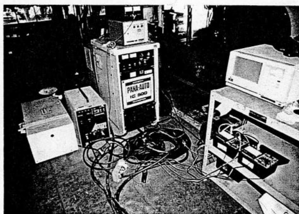
(b) 溶接電源、分流装置、磁化電源、各種計測機器の配置状況
