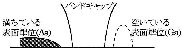
図5-10 GaAs(110)劈開面の電子状態。
