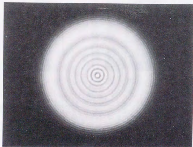
図3-6 円形開口(半径0.5mm)による回折像.
