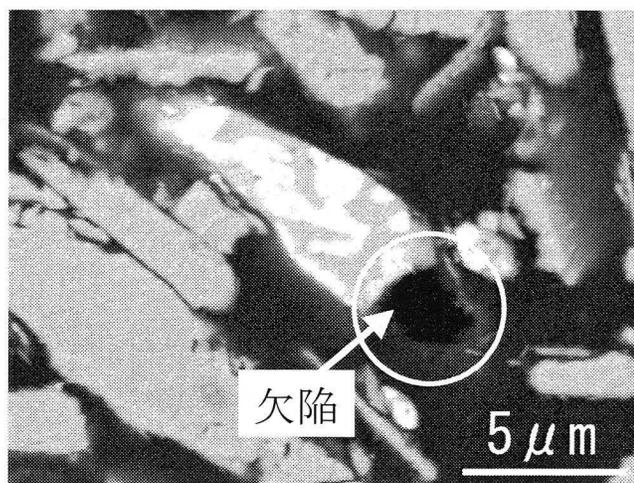
図 4.15 Ag-Sn/Sn-Bi ICA の内部組織 (Ag-Sn/Sn-Bi ICA/Cu, 150℃-500 h 保持後)
