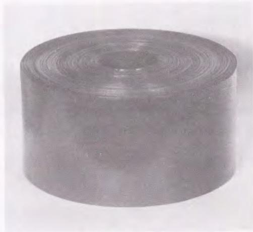
写真4-6 4.5%Si-Fe急冷薄帯（モーターコア用サンプル）
