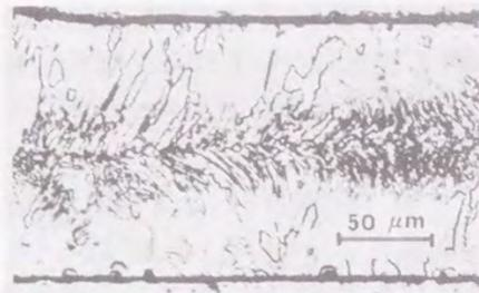
写真4-1 4.5%Si-Fe薄帯の凝固組織
