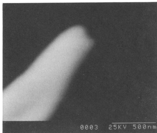
図 2-8 電極先端部のSEM写真 (Pt-Ir:市販品)
