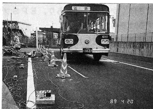
写真6.7 バスによる踏板走行実験
