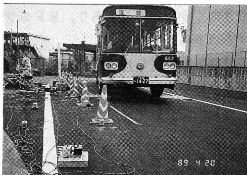
写真6.7 バスによる踏板走行実験
