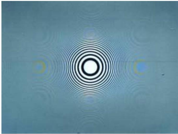
図 3. 17 GOLF を用いた CCD カメラで撮像した CZP チャート
