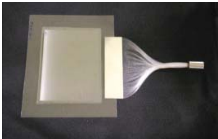
図 6. 10 実際に作製した超薄型バックライト
