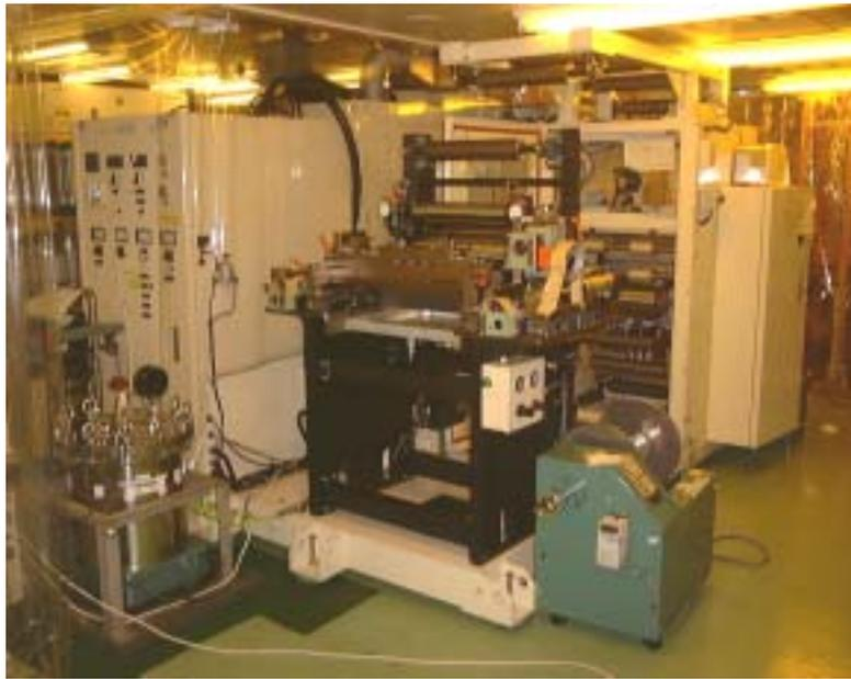
図 2 . 8 実際の連続成型試験装置
