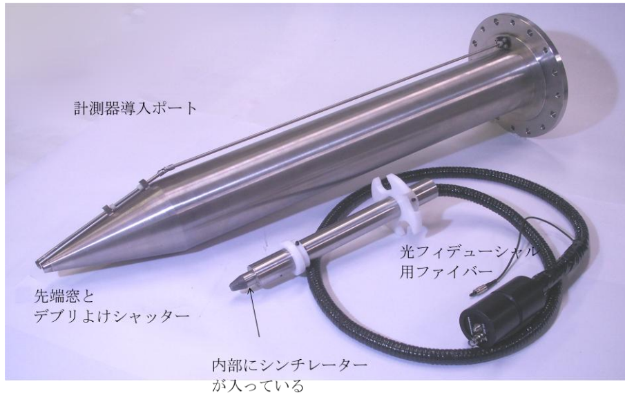
図 27 開発した高速応答中性子計測器
