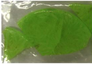
2009-02-09 1100°C, 1h 溶融後, 炉冷 かなりの結晶が析出
