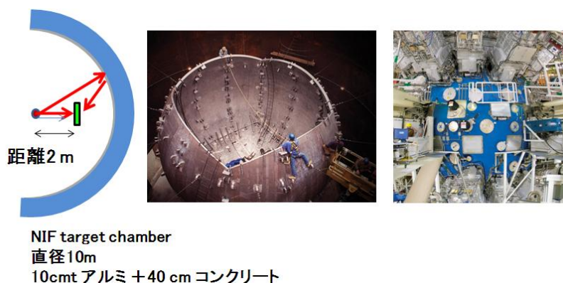
図 8. 計算に用いた NIF ターゲットチャンバーのモデルと、実際の NIF ターゲットチャンバーの写真
