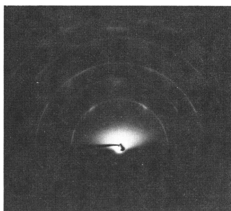
図7-7 ターゲット表面の電子回折像 プレスパッタ時間; 10分間 イオンエネルギー; 1 keV イオン電流密度; 0.58 \text{ mA}/\text{cm}^2
