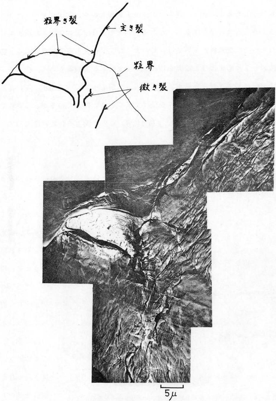
図3-7 焼鈍材の粒界を通る主き裂のレプリカ電子顕微鏡写真  $N = 5 \times 10^4$
