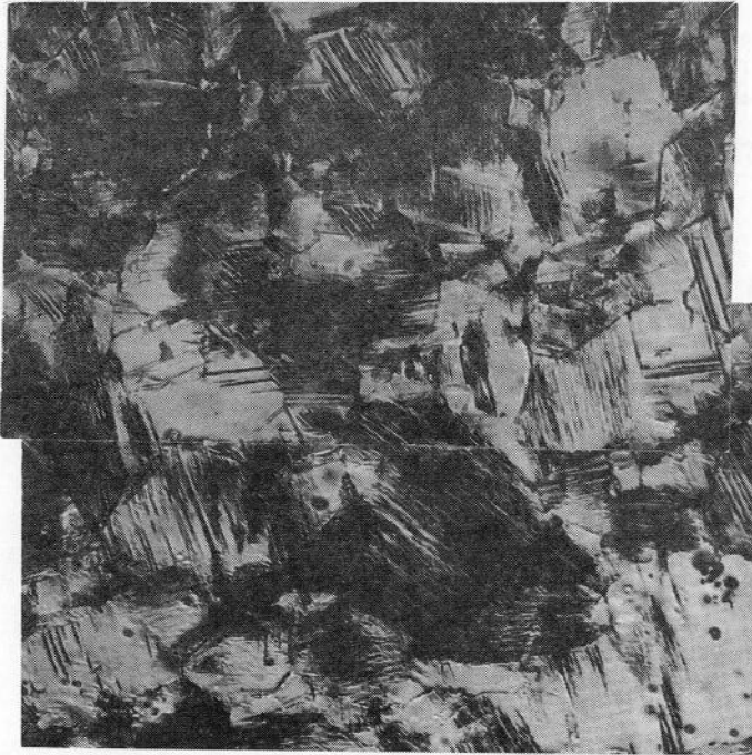
図6-17 焼鈍材の疲労過程中の光学顕微鏡写真
