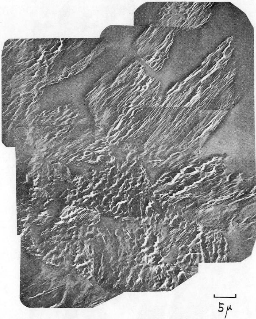
図 6-21 平行材の低応力振幅領域での疲労過程中のレプリカ電子顕微鏡写真 \sigma = 10 \text{ Kg/mm}^2 , N = 1.3 \times 10^7
