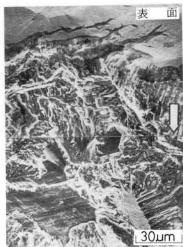
図 4.4.11 30%加工材の SCC 破面形態(水素フリー)。矢印は割れの伝播方向を示す。
