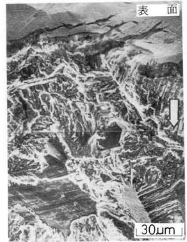
図4.4.11 30%加工材のSCC破面形態(水素フリー).矢印は割れの伝播方向を示す.
