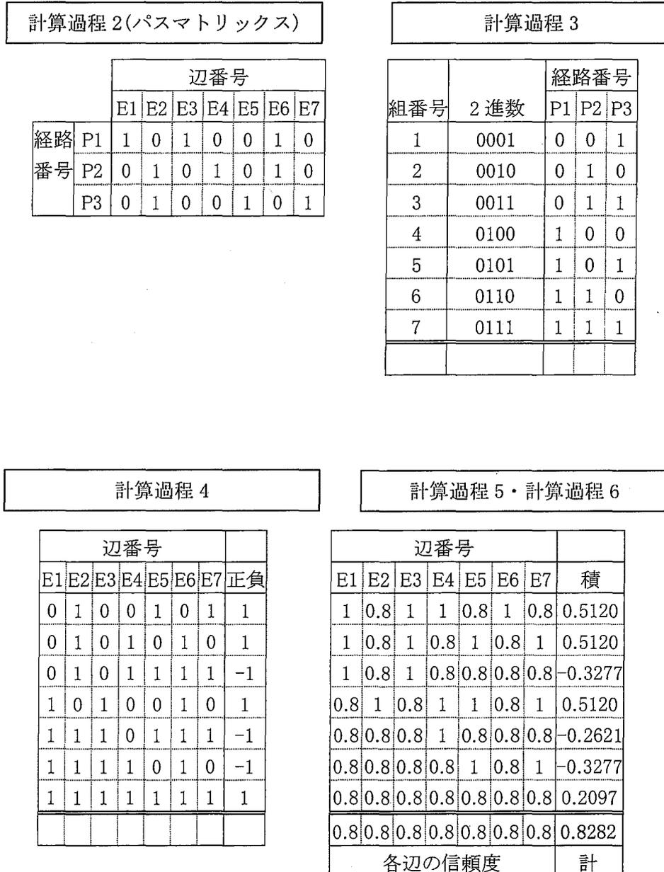
図 3-2 ネットワーク信頼度の計算メカニズム
