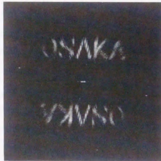
Fig. 2-12. 計算機による再生像 (干渉フィルタを使用しない場合)
