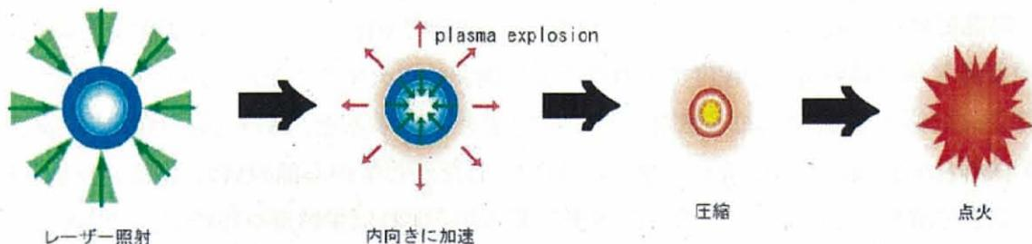
図1.1 レーザー核融合の概念図
