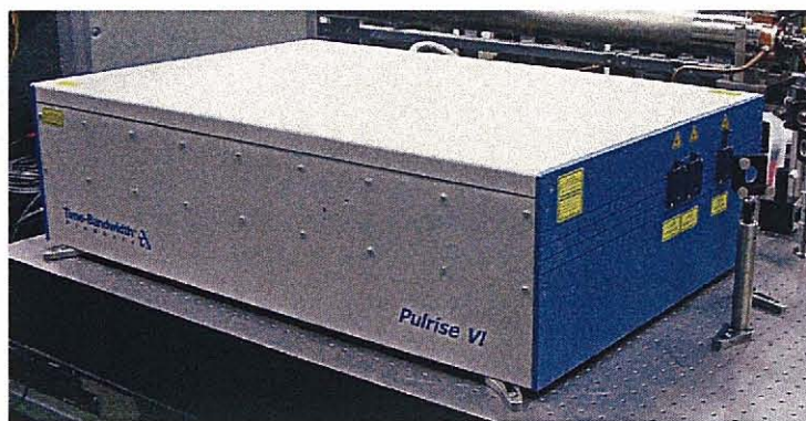
図17 カソード励起用 Nd:YLF ピコ秒レーザーの写真
