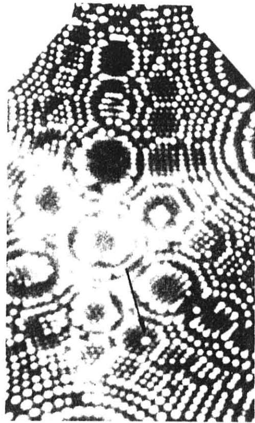
図 2.5 高速中性子照射後のタングステン表面の FIM 観察像 [9]
