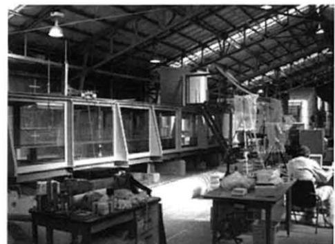
写真-4.3.4.1 台風防災実験水路
