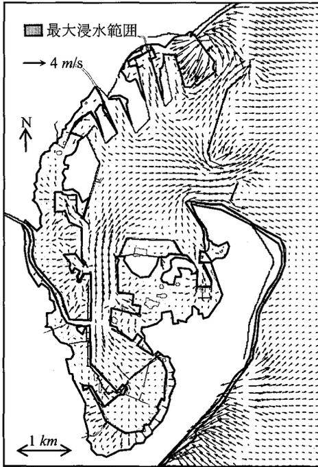
図-4.3.1.2 最大流速及び最大浸水範囲
