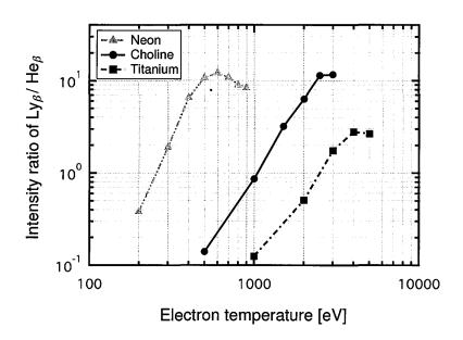
図 4.1 ネオン,塩素,チタンの  $He_{\beta}$  線と  $Ly_{\beta}$  線のライン強度比の電子温度依存性.イオン密度  $n_i=10^{22}~{\rm cm}^{-3}$  と固定して計算を行った.
