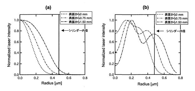
図 5.17 シリンダー径方向へのレーザープロファイル. (a) シリンダー端面照射, (b) シリンダー壁面 照射. 破線はシリンダー表面, 一点鎖線はシリンダー表面からレーザー照射方向へ 0.75 mm, 二点鎖線シリンダー表面からレーザー照射方向へ 1.5 mm のプロファイルを示している.
