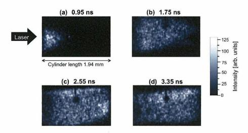
図 5.10 二次元時間分解 X 線画像. (a) 0.95 ns, (b) 1.75 ns, (c) 2.55 ns, (d) 3.35 ns の時間を示している。上の影はターゲットを支えるガラス製の指示棒によって遮蔽されている。
