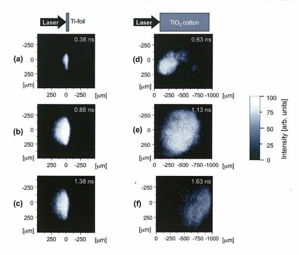
図 5.23 (a)–(c) 厚さ 20  $\mu$ m の平板,(d)–(f) 二酸化チタンナノファイバーコットンターゲットの二次元 時間分解 X 線画像
