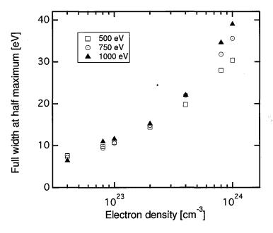
図 2.5 FLYCHK を用いて計算した塩素の Heg 線のライン幅の電子密度・電子温度依存性.
