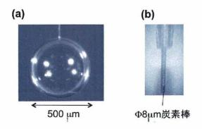
図 4.5 (a) 直径 500  $\mu$ m のガス封入細管付きシェルターゲット. (b) 直径 8  $\mu$ m の炭素棒を用いてガス 封入細管の先端が貫通している様子.
