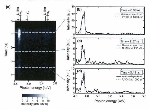
図 5.5 (a) 観測領域を 70–170  $\mu$ m とした時の時間分解チタン K 殼 X 線スペクトル. (b) 0.98 ns, (c) 2.27 ns, (d) 3.45 ns 時の X 線スペクトルを示す。 (b)–(d) において,実線は実験で取得したスペクトルを,破線は FLYCHK コードで予測したスペクトルに計測器の分解能を畳み込んだスペクトルである.
