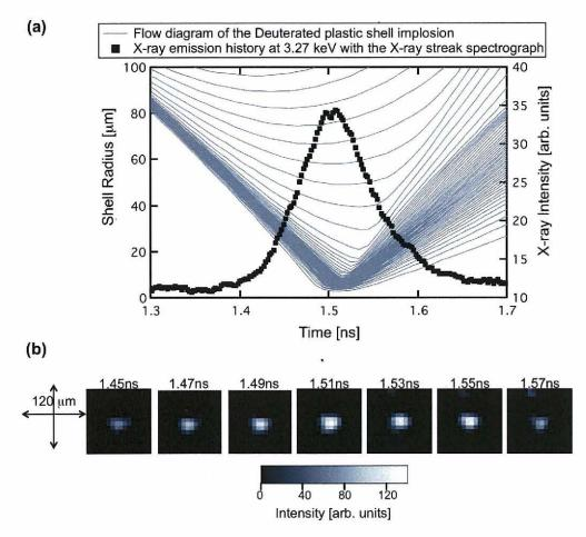
図 3.18 (a) 一次元流体コード ILESTA-1D で計算したシェルの加速軌跡の流線図(実線)と X 線分光 ストリークカメラで取得した 3.27 keV の X 線時間発光履歴(黒四角印)。(b) 単色 X 線サンプリングストリークカメラで取得した 3.27 keV の二次元単色 X 線画像。時間 1.45 ns から 1.57 ns の領域を示している。
