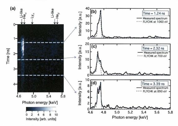
図 5.6 (a) 観測領域を 420– $520 \mu m$  とした時の時間分解チタン K 殼 X 線スペクトル. (b) 1.24 ns, (c) 2.32 ns, (d) 3.39 ns 時の X 線スペクトルを示す. (b)–(d) において、実線は実験で取得したスペクトルを、破線は FLYCHK コードで予測したスペクトルに計測器の分解能を畳み込んだスペクトルである.
