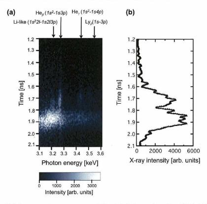
図 4.9 (a) X 線分光ストリークカメラによって取得された塩素の K 殼 X 線の時間発光履歴, (b) 塩素の  $He_{\beta}$  線の時間発光履歴. 時間原点は一次元流体コード ILESTA-1D におけるレーザーパワー最大の 20% の時間である.
