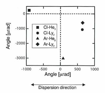
図 A.8 各結晶の結晶表面と格子面のずれのまとめ、原点は結晶表面と格子面がずれていない場合を示している。
