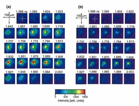
図 4.8 (a) 塩素ドープ爆縮コアプラズマから放射された (a) 塩素  $He_\beta$  線 (3.27 keV), および, (b) 塩素  $Ly_\beta$  線 (3.51 keV) の時間分解単色 X 線画像. フレーム間隔は 19 ps である。 2 つの異なる X 線エネルギーの画像共に同じカラースケールで表示しており、時間原点は一次元流体コード ILESTA-1D と一致させた。時間 1.566 ns の十字はシェル中心を示している。
