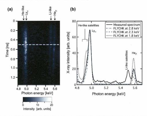
図 5.21 (a) 時間分解チタン K 殼 X 線スペクトル。時間原点は X 線発光履歴の最大の 10% を定義した。(b) (a) の灰色破線で示す時間領域 (電子温度が最大時) のチタン K 殼 X 線スペクトルと,FLYCHK コードを用いて電子密度を  $8.8\times10^{21}$  cm<sup>-3</sup> と固定し電子温度を 1.8 keV, 2.3 keV, 2.8 keV と変化させて計算した時のスペクトル。 X 線スペクトルは分光器のエネルギー分解能で畳み込み,かつ, Ly $_{\alpha}$  線の強度で規格化している。
