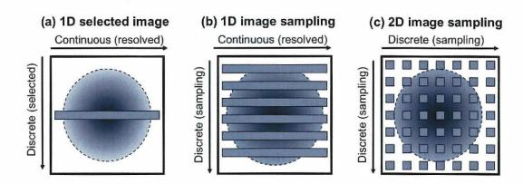
図 3.7 X 線ストリークカメラのフォトカソード上での画像サンプリング. (a) 光源のある場所の 1 次元空間分解計測に限られる. (b) y 方向の 1 次元サンプリング. (c) x,y 方向の 2 次元画像サンプリングによって光源の 2 次元空間情報を得ることが出来る.
