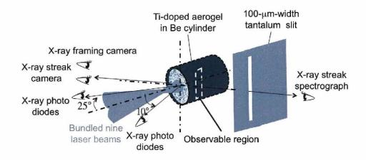
図 5.4 レーザー照射方向と使用計測器の配置。X 線入射視野制限スリットはシリンダー軸中心から 1.5 mm 離した位置に設置した。
