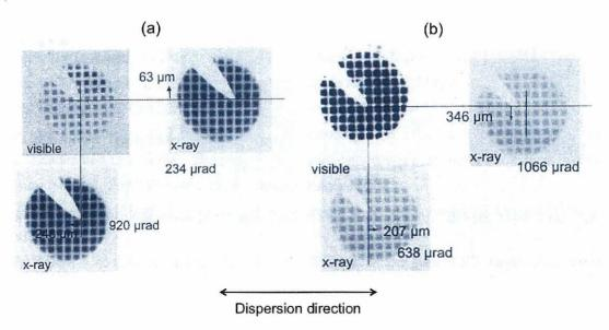
図 A.6 (a) 塩素  $He_{\beta}$  用, (b) 塩素  $Ly_{\beta}$  用の結晶の可視光と X 線の結像点の違いを計測した結果.
