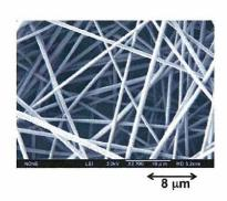
図 5.19 電子スピニング法で製作されたナノファイバーコットンの電子走査型顕微鏡写真.
