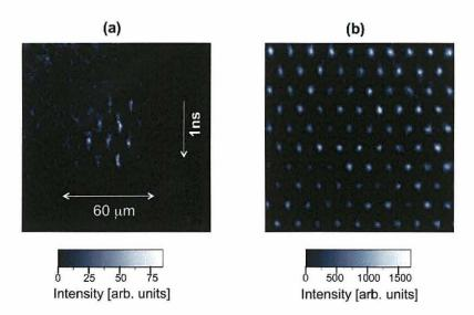
図 3.16 (a) 爆縮コアプラズマから放射される 3.27 keV の単色 X 線掃引画像. (b) サンプリングピンホールの静止画像.
