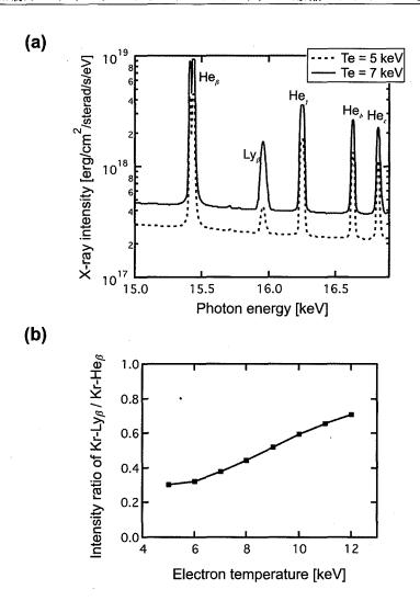
図 4.15 (a) PrismSPECT コードを用いて計算した電子温度が 5 keV と 7 keV 時のクリプトン K 殼 X 線スペクトル. イオン密度  $10^{22}$  cm<sup>-3</sup> として計算を行った。クリプトン (Kr) の  $\text{He}_{\beta}$  線  $(1s^2-1s3p:15.43\text{ keV})$ , $\text{Ly}_{\beta}$  線 (1s-1s:15.96 keV), $\text{He}_{\gamma}$  線  $(1s^2-1s4p:16.25\text{ keV})$ , $\text{He}_{\delta}$  線  $(1s^2-1s5p:16.63\text{ keV})$ , $\text{He}_{\epsilon}$  線  $(1s^2-1s6p:16.81\text{ keV})$  の発光が予測できる。(b) クリプトンの  $\text{He}_{\beta}$  線と  $\text{Ly}_{\beta}$  線 のライン強度比の電子温度依存性。
