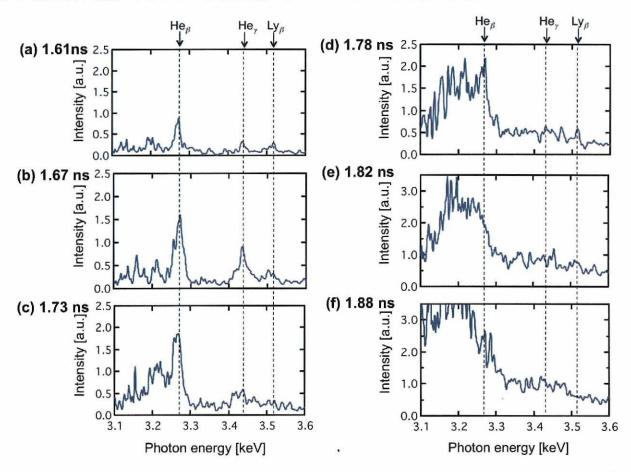
図 4.10 塩素 K 殼 X 線スペクトルの時間変化。(a) 1.61 ns, (b) 1.67 ns, (c) 1.73 ns, (d) 1.78 ns, (e) 1.82 ns, (f) 1.88 ns の時間に相当する。図中の破線は左から塩素の  $He_\beta$  線 (3.27 keV),  $He_\gamma$  線 (3.44 keV),  $Ly_\beta$  線 (3.51 keV) の X 線エネルギーを示している。
