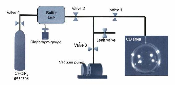
図 4.6 ガス封入装置の概要.
