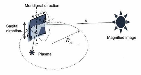
図 3.5 トロイダル湾曲結晶を用いた単色 X 線カメラの原理.
