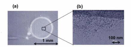
図 5.3 (a) 厚さ  $100~\mu m$  のガラスシリンダーに封入されたチタンドープエアロジェルターゲットの 光学顕微鏡写真. (b) エアロジェルの走査型電子顕微鏡写真. 鎖の様に連なったのがエアロジェルである.
