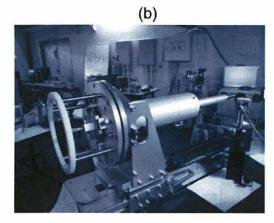
図 A.2 (a) アライメント治具をチャンバーのポートに取り付けた時の様子. (b) アライメント治具をスケルトンに取り付けた時の様子.
