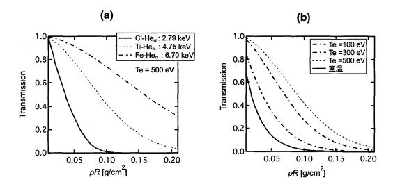
図 5.1 (a) X 線エネルギーを 2.79 keV, 4.75 keV, 6.70 keV と変化させた時の面密度  $\rho R$  と CD プラスチックに対する X 線透過率の関係. (b) 電子温度を変化させた時のチタン K 殻 X 線に対する面密度 と X 線透過率の関係. この 2 つの図から,爆縮コアプラズマの面密度  $\rho R$  は 0.05–0.1 g/cm² と予測されているので,チタンの K 殻 X 線 (4–5 keV) が最適な X 線エネルギーである.
