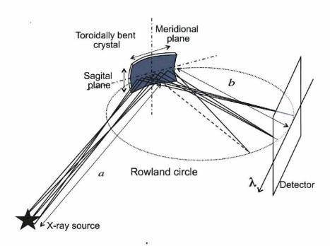
図 3.4 トロイダル湾曲結晶 X 線分光器の原理.
