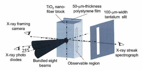
図 5.20 レーザー照射方向と使用計測器の配置. 入射 X 線の視野制限スリットはシリンダー軸中心から 1.5 mm 離した位置に設置した.
