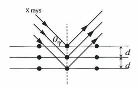
図 3.1 ブラッグ反射の原理、ulletは結晶格子の原子、d は結晶面の間隔、 $heta_B$  はブラッグ角を示している。
