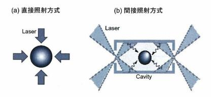
図 1.1 燃料ターゲットを爆縮する方式の概念図. (a) 直接照射方式. (b) 間接照射方式.
