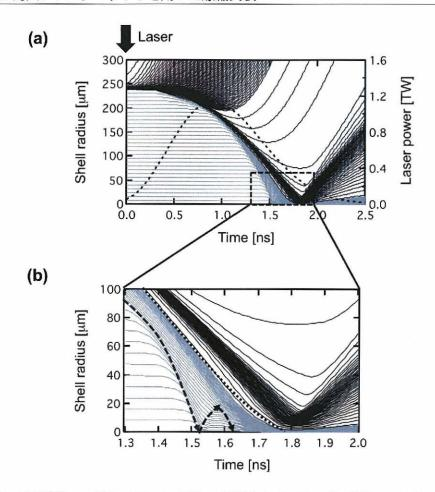
図 4.13 (a) 一次元流体コード ILESTA-1D を用いて予測した CHCIF<sub>2</sub> ガス封入シェルターゲットの爆縮過程. 灰色線は CD シェル, 黒色線は CHCIF<sub>2</sub> ガスの流線図を示す。時間原点をレーザーパワーのピークの 20% とした。(b) (a) の時間 1.3 ns から 2.0 ns の拡大図。破線の矢印は衝撃波の伝搬,点線は CHCIF<sub>2</sub> ガスと CD シェルの接触部分を示している。
