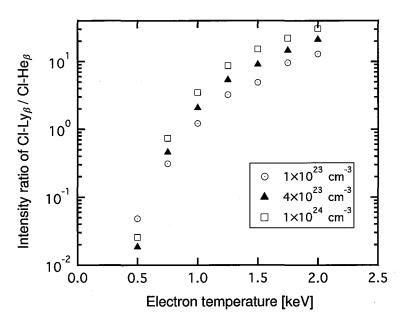
図 2.4 FLYCHK を用いて計算した塩素  $Ly_{\beta}$  線と塩素  $He_{\beta}$  線のライン強度比の電子温度・電子密度依存性.
