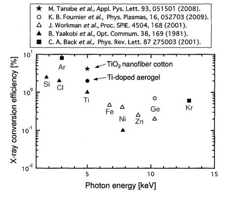
図 5.24 平板ターゲットと低密度ターゲットの K 殼 X 線変換効率の比較. 黒四角印はガスターゲット, 黒三角印と白抜き三角印は平板ターゲット, 黒丸印と白抜き丸印は金属ドープエアロジェルターゲット, 星印はナノファイバーコットンターゲットの変換効率を示す.
