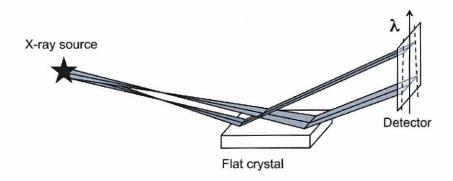
図 3.2 平板結晶 X 線分光器の原理.
