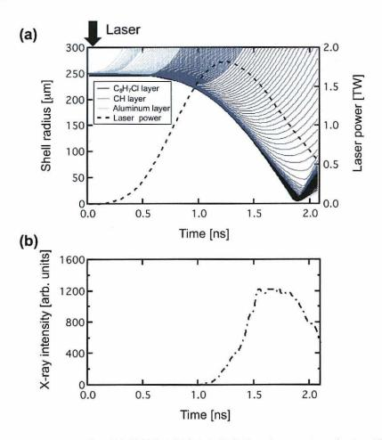
図 4.3 (a) ILESTA-1D コードで完全球対称を仮定した塩素ドープシェルターゲットの流線図とレーザーの時間波形.  $C_8H_7Cl$  層を黒色の実線,CH 層を濃い灰色の実線,アルミニウム層を薄い灰色の実線,レーザー波形を破線で示している。(b) X 線分光ストリークカメラで計測した塩素  $He_\beta$  線の時間発光履歴.
