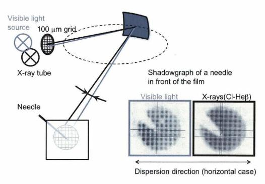
図 A.5 湾曲結晶の可視光と X 線の結像点の違いを計測するための実験配置。
