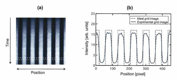
図 3.13 (a) 格子のストリーク像. (b) (a) 中における白破線部分を時間積分したラインプロファイル. 実線が実験で取得した格子のプロファイル, 破線が理想的な格子のプロファイルを示す.
