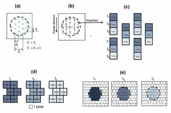
図 3.9 2 次元再構成の手順. (a) サンプリングピンホールを通過した後の X 線画像. (b) ピンホール像を時間掃引した X 線画像. 時間掃引方向は図中の上から下である. (c) (b) を拡大した画像.  $t_1 < t_2 < t_3$ である. (d) ピンホールの絶対座標と (c) を用いて各時間毎に再構成した像. 上下の段で横方向にシフト量  $\delta_x$  あたりずらして並べ替える. (e) 再構成した時間分解二次元 X 線画像.
