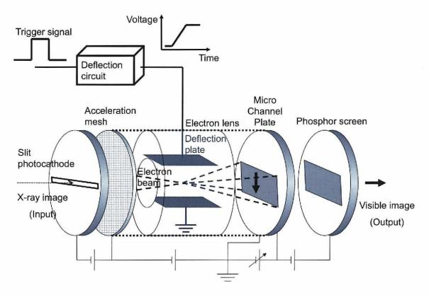
図 3.6 X 線ストリークカメラの原理。
