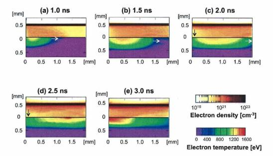
図 5.11 RAICHO で計算した (a) 1.0 ns, (b) 1.5 ns, (c) 2.0 ns, (d) 2.5 ns, (e) 3.0 ns 時の二次元円柱軸対照の電子温度・電子密度分布。全ての図に対して、上図が電子密度  $[cm^{-3}]$ ,下図が電子温度 [eV] を示しており、レーザー光は図中の左から照射されている。図 (a),(b),(c) の白矢印はシリンダー軸方向に加熱領域が拡がっていることを示し、図 (c),(d) の黒矢印はシリンダー壁面から膨張したプラズマの様子を表している。
