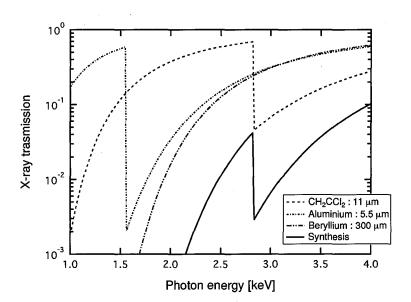
図 3.12 X 線ストリークカメラの空間分解能評価実験で使用したフィルターの X 線透過率. 破線は サラン  $11~\mu m$ , 一点鎖線はアルミニウム  $5.5~\mu m$ , 二点鎖線はベリリウム  $300~\mu m$ , 実線は合成フィルターの透過率を示している.
