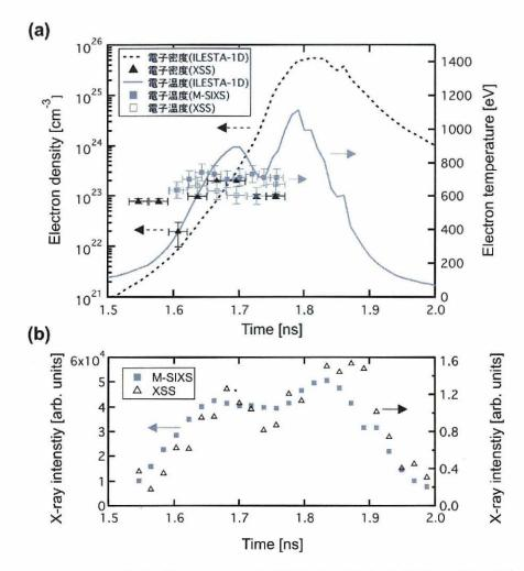
図 4.14 (a) ILESTA-1D で計算を行い CHCIF<sub>2</sub> の空間領域を平均した電子温度・密度の予測と実験結果の比較、ILESTA-1D で予測した電子温度を実線、電子密度を破線で示す。X 線分光ストリークカメラで取得したスペクトル拡がりから求めた電子密度を黒丸印、ライン強度比から求めた電子温度を白抜き四角印、単色 X 線サンプリングストリークカメラのライン強度比から求めた空間平均電子温度を黒四角印で示す。(b) X 線分光ストリーク (XSS) カメラと単色 X 線サンプリングストリークカメラ (M-SIXS) で取得した 3.27 keV の X 線発光時間履歴。
