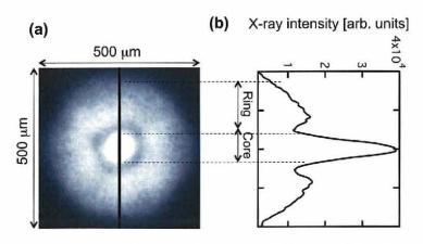
図 4.4 (a) X 線ピンホールカメラで取得した時間積分二次元塩素  $\mathrm{He}_{\alpha}$  準単色画像。(b) 中央線の発光 強度プロファイル。
