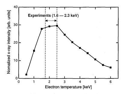
図 5.22 FLYCHK を用いて計算したレーザー波長 351 nm の臨界密度でのチタンの K 殻 X 線強度の電子温度依存性、縦軸は、4.0–6.0 keV の X 線強度をプラズマの内部エネルギーで規格化している。
