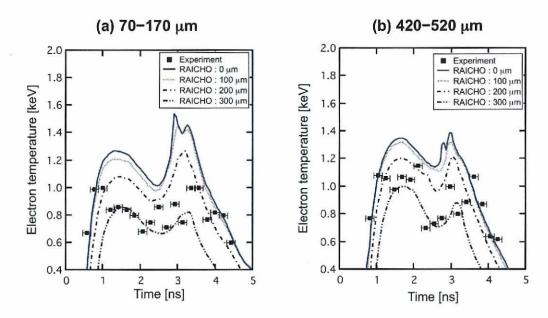
図 5.13 X 線スペクトル解析から導出した電子温度の時間履歴と RAICHO で計算した電子温度の比較。シリンダー軸近傍の電子温度履歴を実線、軸から径方向へ 100  $\mu$ m の領域を点線, 200  $\mu$ m の領域を一点鎖線, 300  $\mu$ m の領域を二点鎖線で表している。(a) 70–170  $\mu$ m の観測領域。(b) 420–520  $\mu$ m の観測領域。
