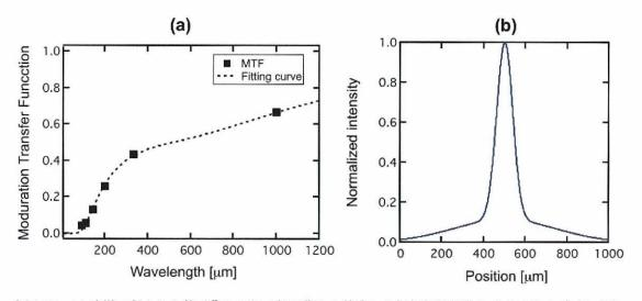
図 3.14 (a) 実験で得られた格子像と理想の格子像から算出した振幅伝達関数と式 (3.18) のダブルガウス関数でフィッティングした振幅伝達関数. (b) (a) の振幅伝達関数を逆フーリエ変換して求めたストリークカメラの点拡がり関数.
