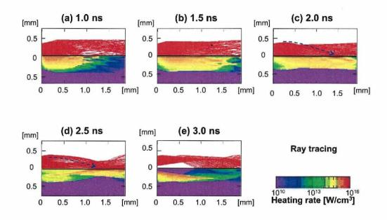
図 5.12 RAICHO で計算した (a) 1.0 ns, (b) 1.5 ns, (c) 2.0 ns, (d) 2.5 ns, (e) 3.0 ns 時二次元円柱軸対照 の光線追跡・レーザー加熱率の結果。全ての図に対して、上図がレーザー光線追跡、下図がターゲットの加熱率 [W/cm³] を示しており、レーザー光は図中の左から照射されている。図 (c),(d) 中の青矢印はレーザー光の一部がプラズマに反射されている様子を表している。
