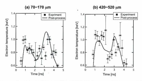
図 5.15 X 線スペクトルから導出した電子温度の時間履歴(点)と RAICHO の結果と FLYCHK を用いて行ったポストプロセス計算で求めた電子温度(線)の時間履歴の比較. (a) 70–170  $\mu$ m の観測領域, (b) 420–520  $\mu$ m の観測領域.
