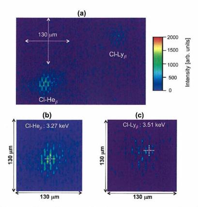
図 4.7 (a) 爆縮コアプラズマから放射された単色 X 線サンプリングストリーク像. 塩素  $He_\beta$  線の単色 X 線像と塩素  $Ly_\beta$  線の単色像が同時にストリークカメラのカソード上で取得されている. (b) 塩素  $He_\beta$  線,および,(c) 塩素  $Ly_\beta$  線のサンプリングストリーク像。全ての図は同じカラースケールで表示しており,(b),(c)の十字はシェル中心を示している。
