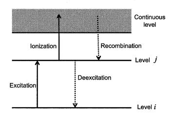
図 2.2 プラズマ中の原子過程一例の模式図. 実線の矢印は束縛電子がエネルギーを得てエネルギーの低い束縛準位 j から高い束縛準位 j に励起,あるいは;高い束縛準位 j から連続準位へ電離する過程の例を示し,点線の矢印は束縛電子がエネルギーを失って低いエネルギー準位 j へ脱励起,あるいは,自由電子がエネルギーを失って捕獲され再結合する過程の例を示している.
