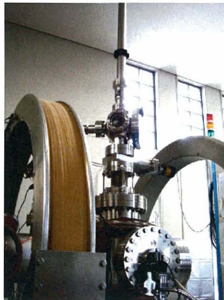
Fig. 2.28 サンプルチャンバー上部ロードロックチャンバー
