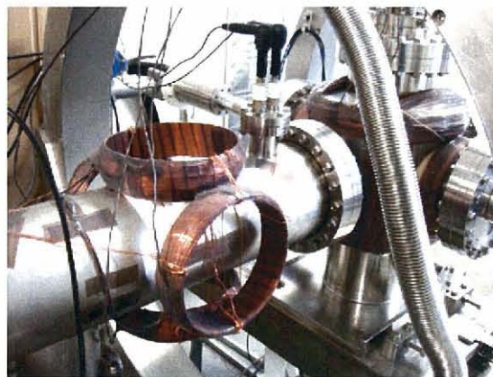
Fig. 2.31 ビーム位置調節用偏向コイル
