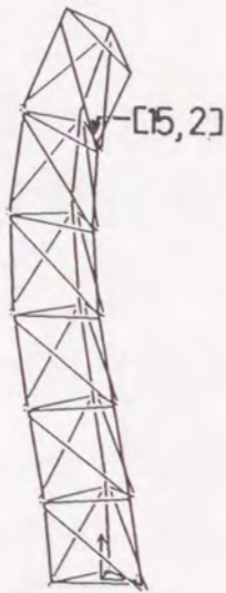
(c) ジョイント [15, 2] の回転角が有効な制約となる ( \theta_{Wy} = 44(\text{deg}) )
