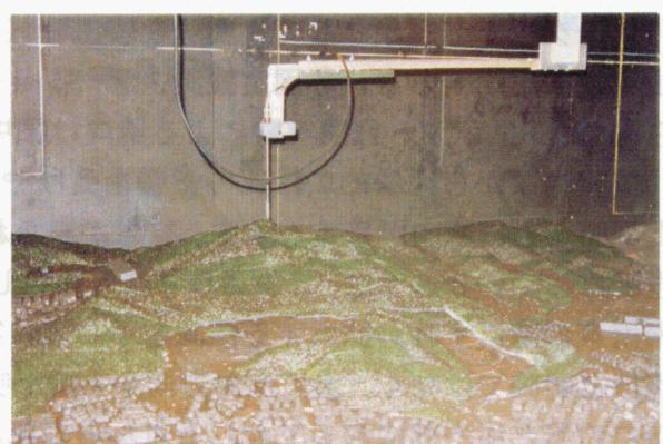
写真5.6 3次元トラバースを用いた測定風景
