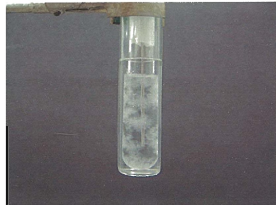
(b) 実験開始から 3 分経過後の状態 (白色の結晶が析出し始めた状態)
