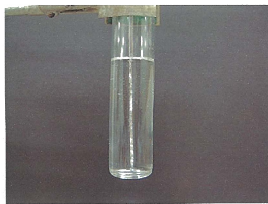
(d) パラフィン内部温度 25.4 °C (白色の固体状態)
