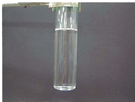
(d) パラフィン内部温度 26.5 °C (完全な透明の液体状態)
