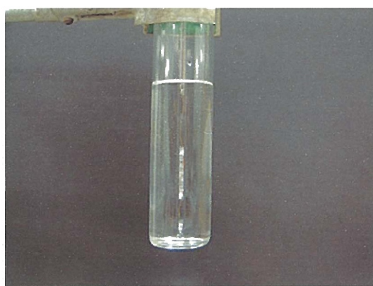
(b) パラフィン内部温度 25.6 °C (白色の結晶が析出し始めた状態)
