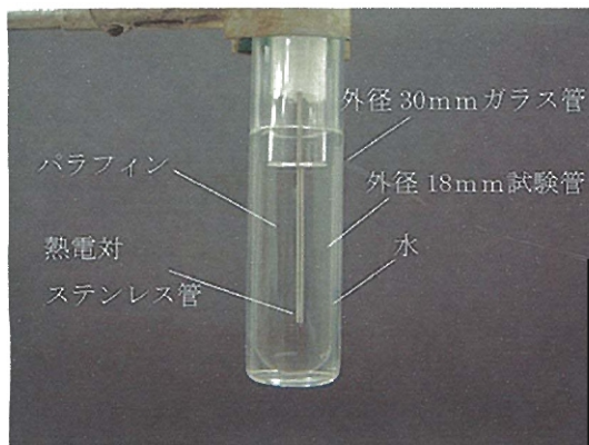
(a) パラフィンの液体状態 (透明な液体状態)
