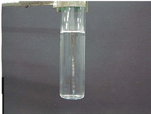
(c) パラフィンの内部温度 26.4 °C (透明の液体が大部分を占めた状態)
