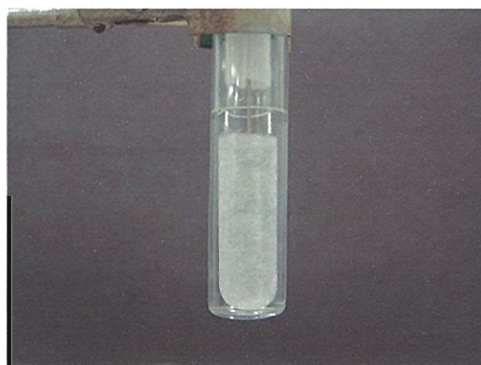
(d) 実験開始から 15 分経過後の状態 (さらに結晶が成長している状態)
