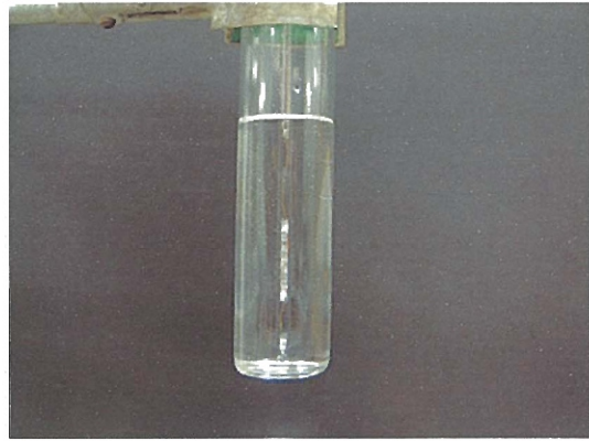
(b) パラフィン内部温度 25.6 °C (白色の結晶が析出し始めた状態)
