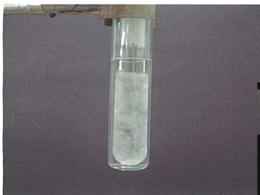
(c) 実験開始から 10 分経過後の状態 (結晶が成長し始めた状態)
