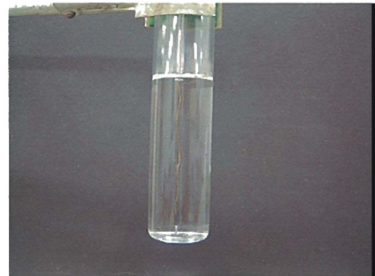
(d) パラフィン内部温度 26.5 °C (完全な透明の液体状態)
