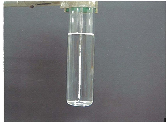
(b) パラフィン内部温度 26.1 °C (周囲がやや透明がかった状態)
