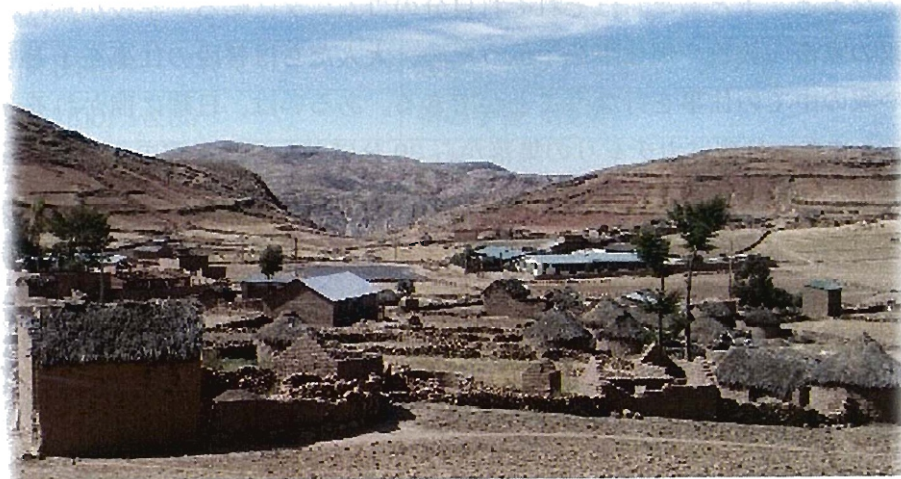
写真3-3. 村の住居 アドベ（土レンガ）と糞の屋根からなる村の住居。中央のトタン屋根を持つ建物が教会。遠くに見える青い屋根の建物がインターネットナード。
