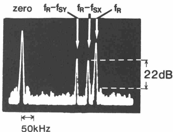
図6.10 スイッチングゲートを駆動しないときに観測した周波数スペクトル
