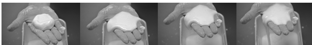
図 3.3 ダイラタント流体の物性変化の様子
