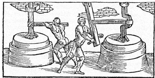
図3 中世ヨーロッパにおける石臼粉碎機を利用したアマルガム化
