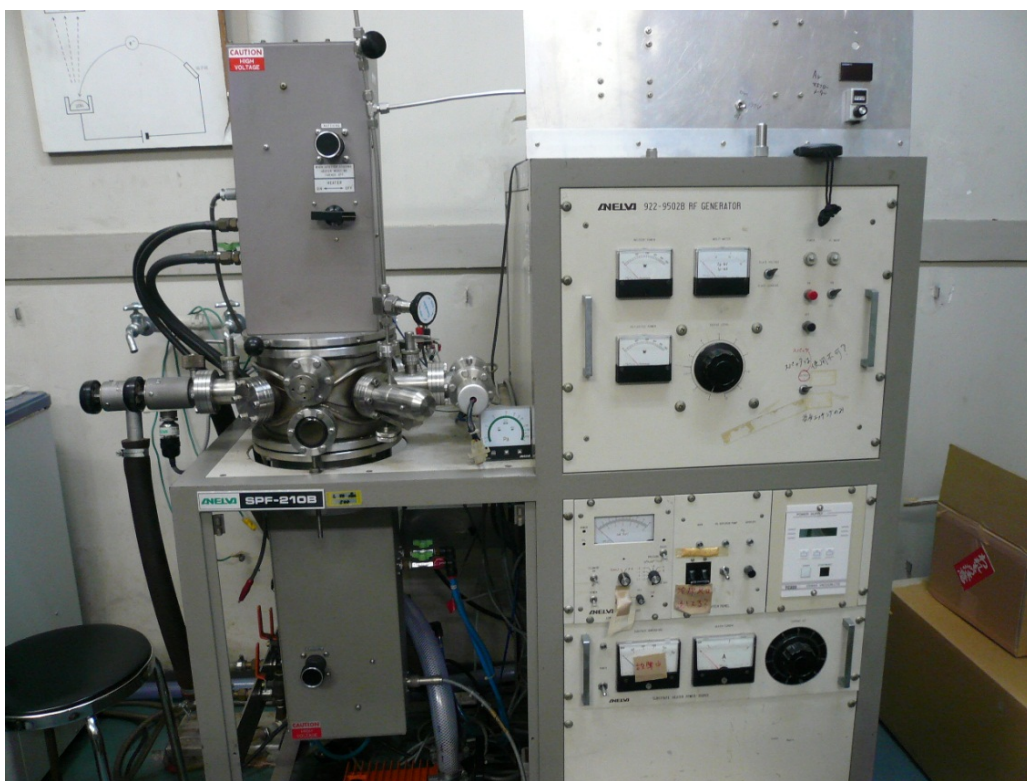
Fig. 4-1 RF マグネトロンスパッタ装置（アネルバ製 SPF-210B ）
