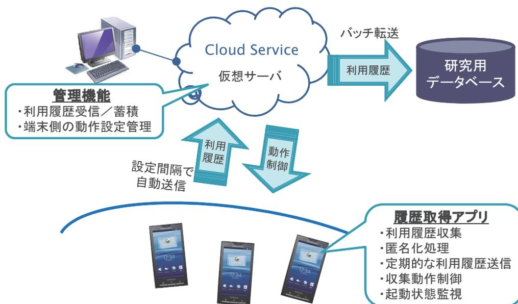
図 A.5 利用履歴収集システム
