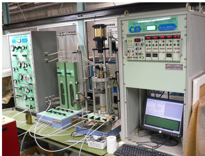
写真 2.3.4 透水試験状況
