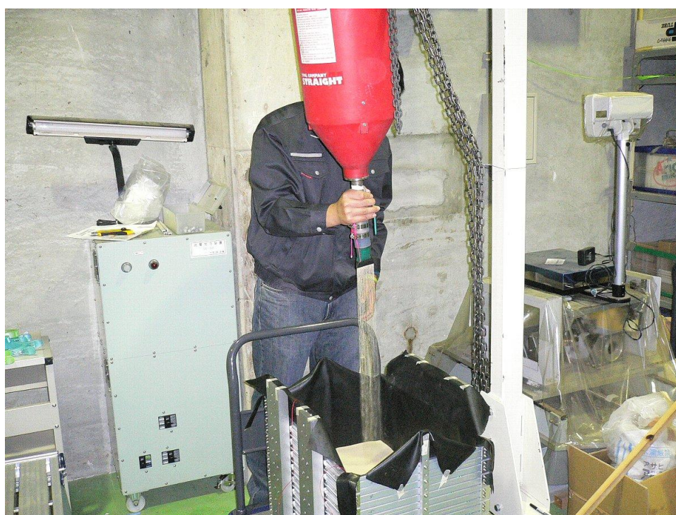
写真 4.2.3 空中落下法による模型地盤の作製 (イメージ)
