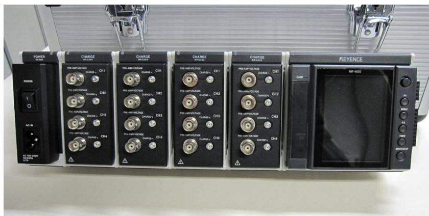
写真 3.2.4 加速度計測ユニット
