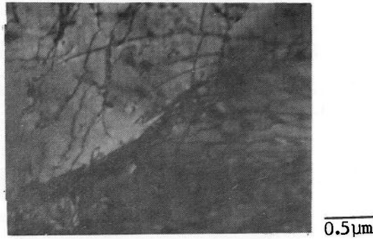
写真 2-11 520°C, \dot{\epsilon} \sim 10^{-1} \text{sec}^{-1} で ~20% 引張変形した試料 D の \alpha 相の電顕組織
