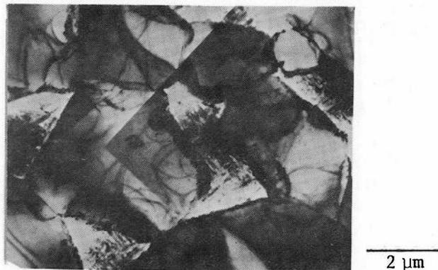
写真4-3 800℃に保持後放冷したB試料の電顕組織
