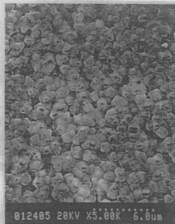
図 3-5: リンドープ多結晶ダイヤモンド薄膜の SEM 像(1)
