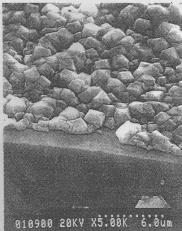
図 3-6: リンドープ多結晶ダイヤモンド薄膜の SEM 像(2)
