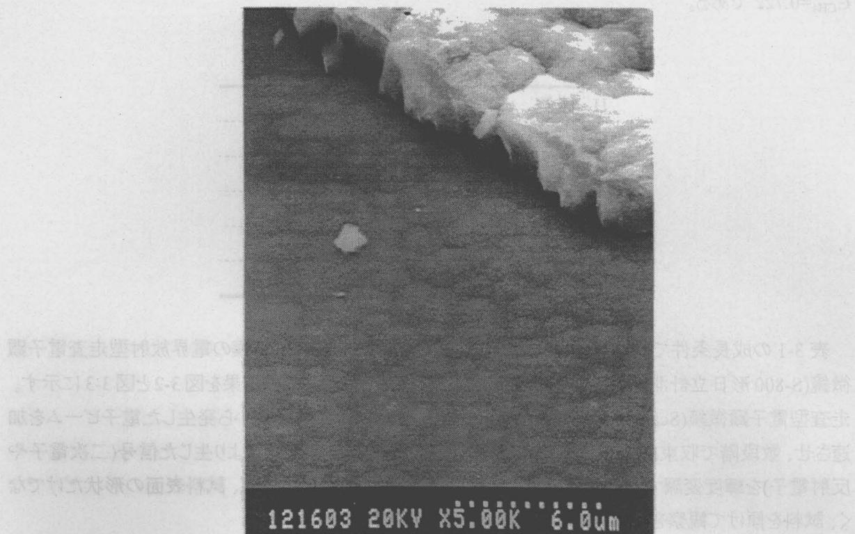
図 3-3: アンドープ多結晶ダイヤモンド薄膜の SEM 像(2)
