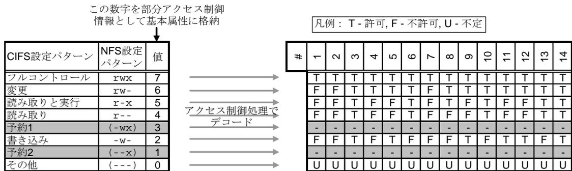
図 2.5 格納方式 S の概要
