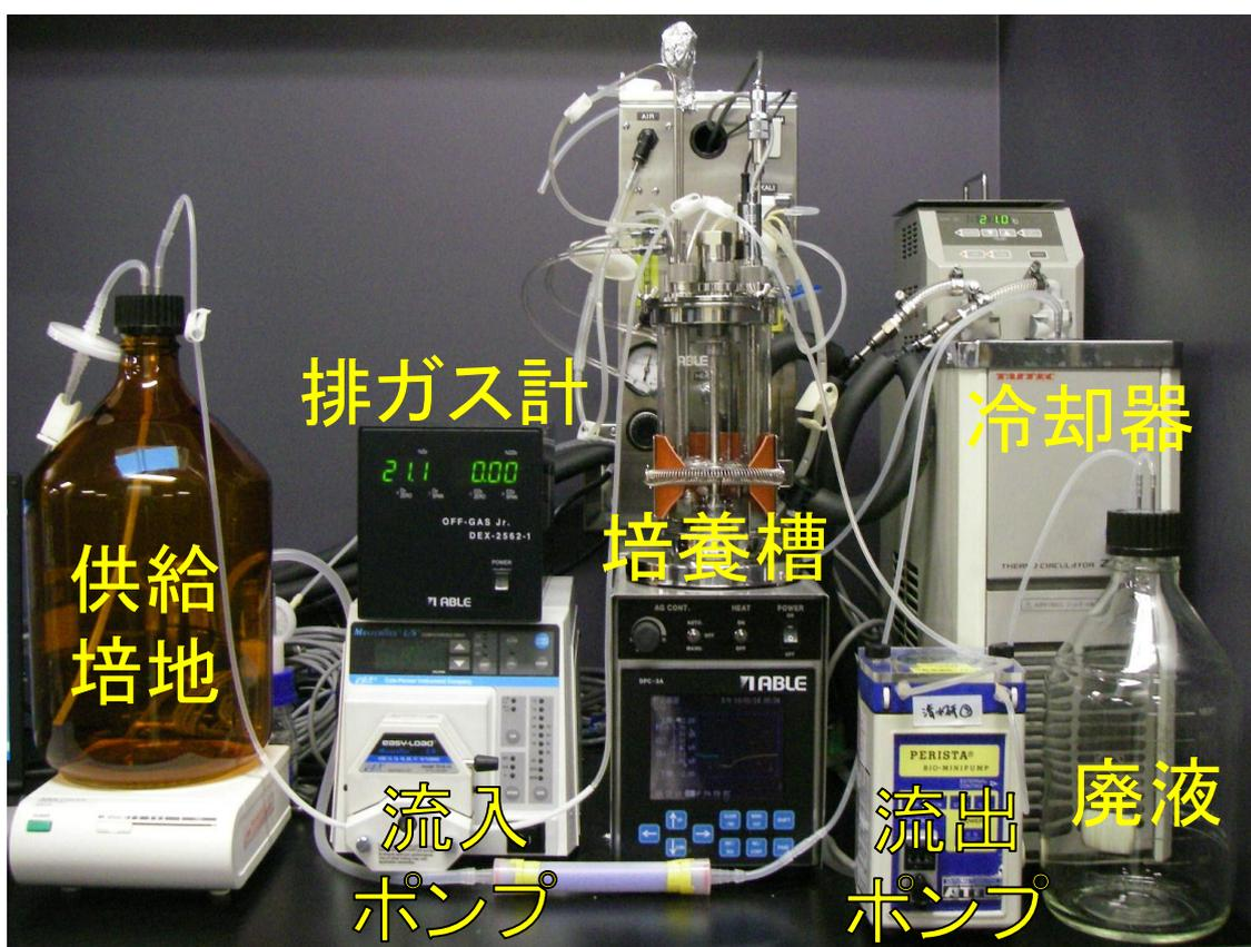
Fig. 2-1 構築した連続培養系
