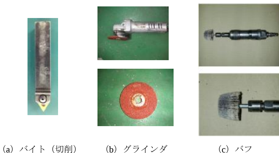
Fig.2-1 600 合金溶接部で使用される加工工具の例
