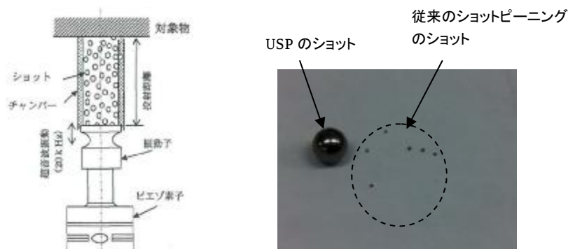
Fig.2-12 USP の原理[22]およびショットの比較
