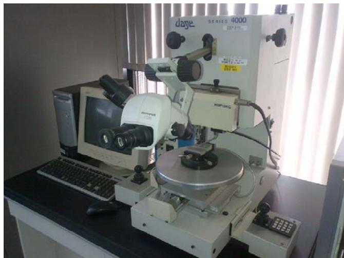
図4.1 プル強度測定装置の外観写真.
