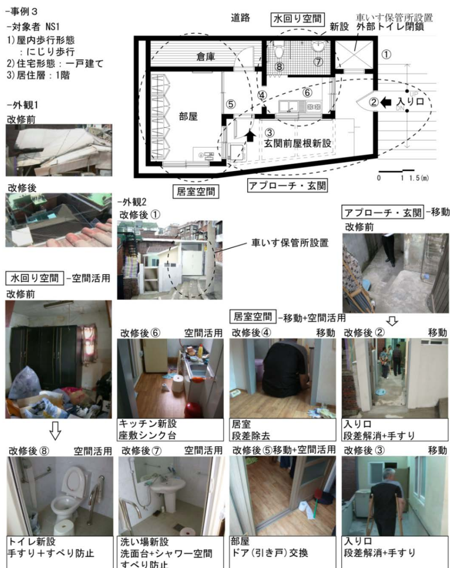
図3-8 事例3(一戸建て)の改修前後の状況
