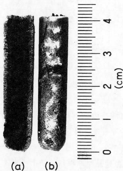
図3-2 \text{CuGaS}_2 多結晶インゴット。(a)断面、(b)外観。インゴット外周部はオレンジ色の結晶であり、中心部は黒色の結晶である。
