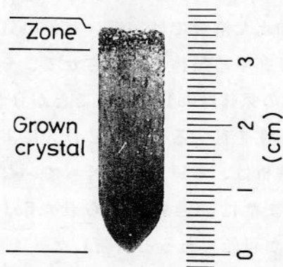
図5-7 CuI溶媒を用いたTHM成長によって得られたCuGaS 2 バルク単結晶。THMのzoneの溶質組成比は、Cu:Ga:S=1.1:1.2:2となるように調製した。
