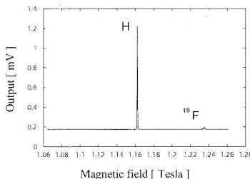
図 1 偏極 HD 標的の NMR シグナル。磁場スイープにより測定した。左に見えるピークは H(水素)、右はセルに含まれる  $^{19}\text{F}$ (フッ素)のシグナル。測定した偏極度は  $41\% \pm 3\%$  であった(2009 年の解析結果)
