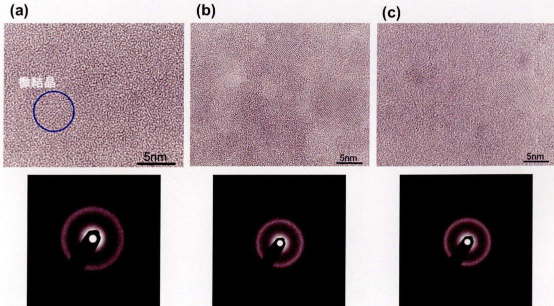
図 2.11 熱処理前の HfO<sub>2</sub> 膜の平面 TEM 像と電子線回折パターン(上段: 平面 TEM 像, 下段: 電子線回折パターン) ; (a): 化学酸化膜付き Si 基板上, (b): 酸化膜除去 Si 基板上, (c): 熱酸化膜付き Si 基板上.
