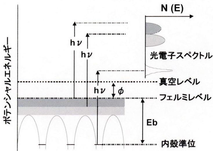
図 5.19 固体からの光電子放出の模式図。
