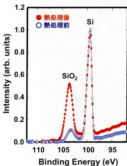
図 2.7 熱処理前後の化学酸化膜付き Si 基板上の HfO<sub>2</sub> 膜から得られた Si 2*p* スペクトル。
