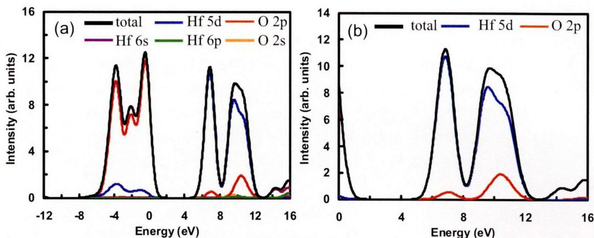
図 5.13 DV-X $\alpha$  法により計算した cubic HfO<sub>2</sub> の Density of State (DOS), 空間群 : Fm $\bar{3}$ m, クラスタ内の原子数: 85 による計算結果; (a): 価電子帯上端から伝導帯下端の DOS の特徴, (b): 伝導帯下端付近の DOS の拡大図.
