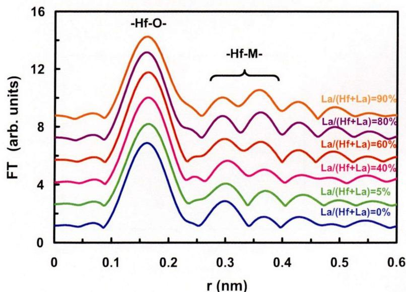
図 5.8 HfLaO 膜の動径分布関数の変化 [ $\text{La}/(\text{La}+\text{Hf})=0\%, 5\%, 40\%, 60\%, 80\%, 90\%$ ]
