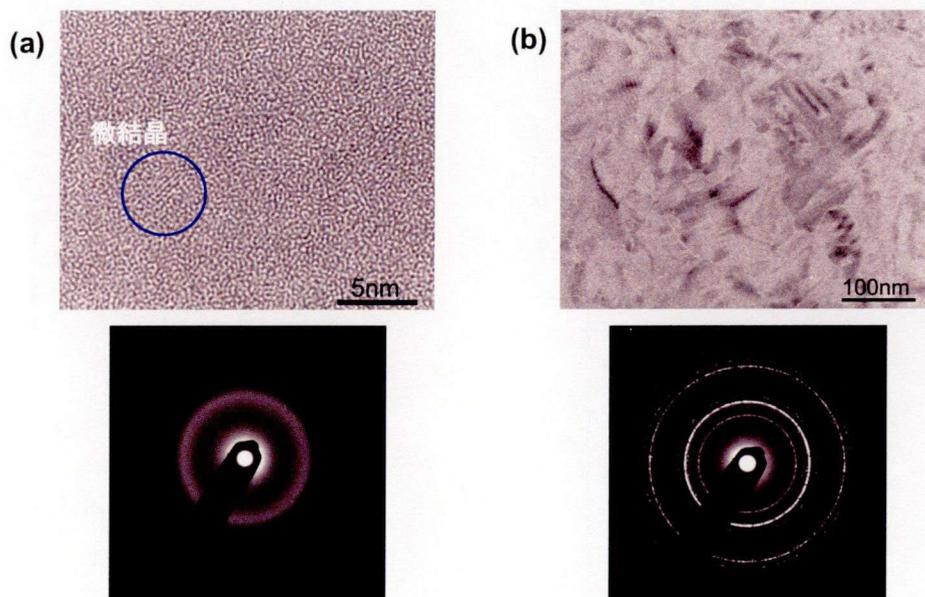
図 2.6 熱処理前後の化学酸化膜付き Si 基板上的 HfO<sub>2</sub> 膜の平面 TEM 像と
