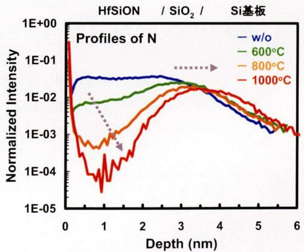
図 3.6 HfSiON 膜の熱処理による N デプスプロファイルの変化 (一次イオン種: Cs<sup>+</sup>、二次イオン種: CsN<sup>+</sup>)。
