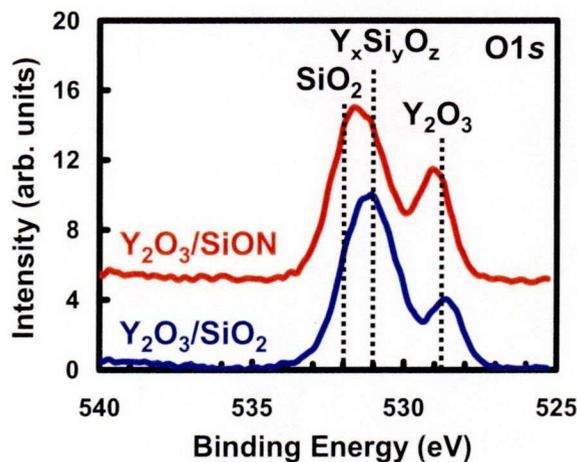
図 4.5 化学酸化膜と酸窒化膜上に  $Y_2O_3$  膜を成膜した試料 (熱処理前) から得られた O 1s スペクトル。
