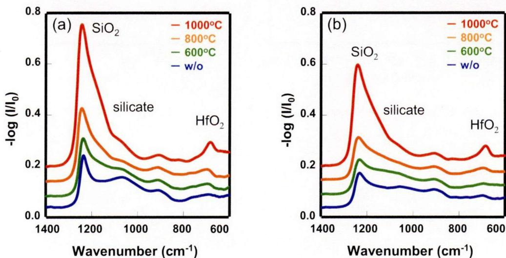
図 3.4 HfSiO<sub>x</sub> 膜および HfSiON 膜の熱処理（600°C, 800°C, 1000°C）による FT-IR ATR スペクトルの変化; (a): HfSiO<sub>x</sub> 膜, (b): HfSiON 膜.
