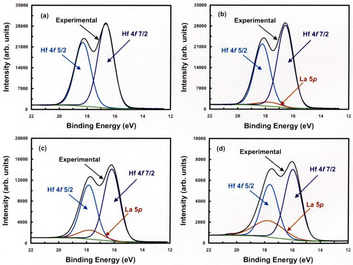
図 5.22 HfLaO 膜の XPS 分析から得られた Hf 4f スペクトルのピーク分割結果；
