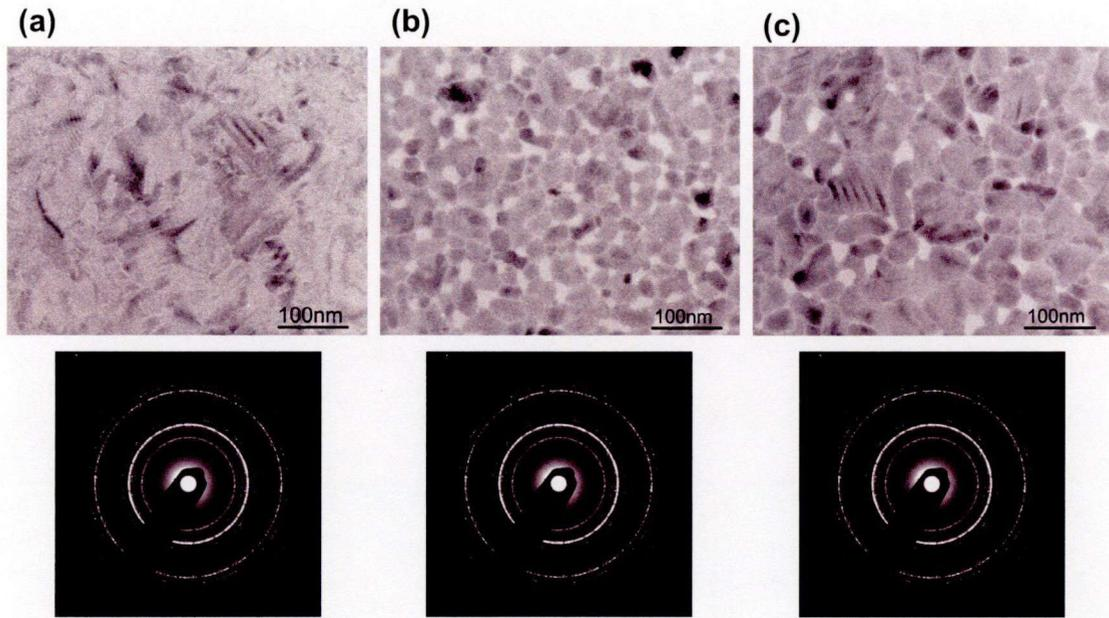
図 2.12 熱処理後の HfO<sub>2</sub> 膜の平面 TEM 像と電子線回折パターン（上段：平面 TEM 像，下段：電子線回折パターン）；(a): 化学酸化膜付き Si 基板上, (b): 酸化膜除去 Si 基板上, (c): 熱酸化膜付き Si 基板上.
