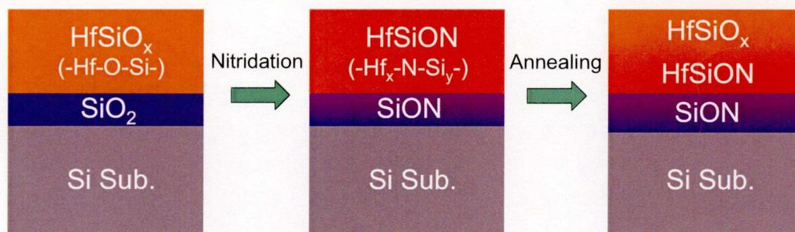
図 3.7  $\text{HfSiON}$ 膜の窒化処理時および熱処理時の構造変化モデル。
