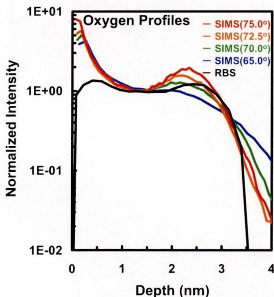
図 3.13 D-SIMS 分析と RBS 分析の O デプスプロファイルの比較。
