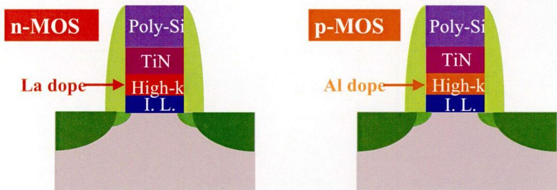
図 5.3 Single-metal Dual-high-*k* ゲートスタック構造; 1 種類のメタルゲート電極と 2 種類の high-*k* ゲート絶縁膜を用いることで n-MOS と p-MOS が作製出来る。また、ゲート電極全体は Poly-Si と薄いメタル膜で構成された MIPS (Metal Inserted Poly-Silicon) 構造であり、Poly-Si の空乏化の問題を回避するとともに、Poly-Si の優れた加工特性を生かすことが出来る。
