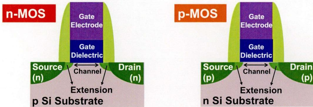
図 1.2 n-MOSFET と p-MOSFET の概念図。
