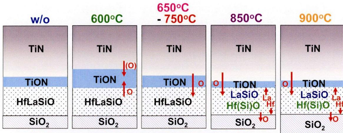
図 6.13 TiN/HfLaSiO/Si ゲートスタックの熱処理による構造変化に関するモデル図; TiON/HfLaSiO/SiO<sub>2</sub> 全体の膜厚は XPS 分析の検出深さから 10 nm 以内と判断できる, TiON 層と SiO<sub>2</sub> 層の厚みに関する相対的な変化はバックサイド XPS 分析から推定される, 図中の矢印は原子の移動方向を表す.
