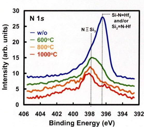
図 3.5 HfSiON 膜の熱処理 (600°C, 800°C, 1000°C) による N 1s スペクトルの変化。
