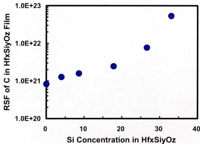
図 3.10  $\text{Hf}_x\text{Si}_y\text{O}_z$  膜の組成と C の RSF の関係。
