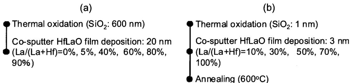
図5.4 HfLaO膜作製フロー; (a): HfLaO厚膜試料 (HfLaO:20 nm / SiO<sub>2</sub>: 600 nm / Si Sub.) , (b): HfLaO 薄膜試料 (HfLaO: 3 nm / SiO<sub>2</sub>: 1 nm / Si Sub.) .
