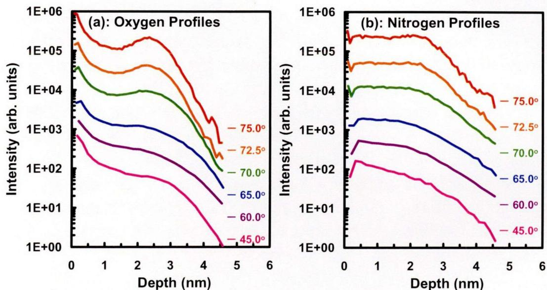
図 3.12 HfSiON 膜 (No.3) の D-SIMS 分析から得られた CsO<sup>+</sup> と CsN<sup>+</sup> の一次イオン入射角依存性 (一次イオン種: Cs<sup>+</sup>, 二次イオン種: CsO<sup>+</sup> および CsN<sup>+</sup>) .
