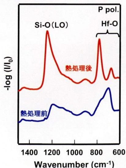
図 2.8 熱処理前後の化学酸化膜付き Si 基板上の HfO<sub>2</sub> 膜から得られた FT-IR スペクトル。
