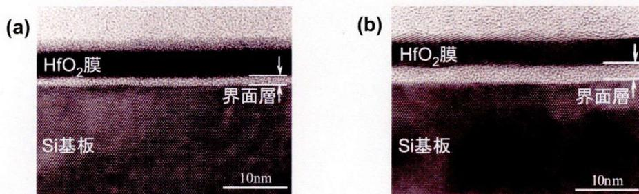
図 2.5 熱処理前後の化学酸化膜付き Si 基板上的 HfO<sub>2</sub> 膜の断面 TEM 像;
