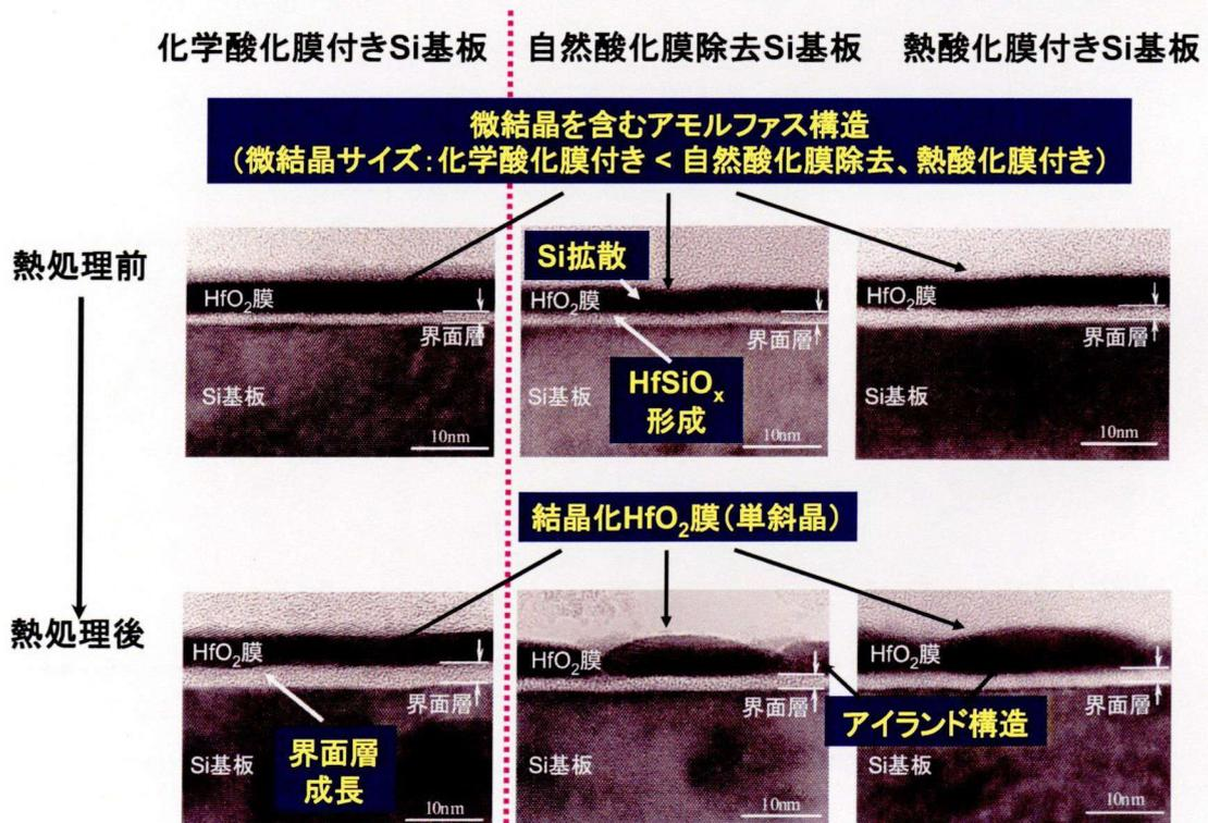
図 2.17 各試料の構造と界面状態の変化.
