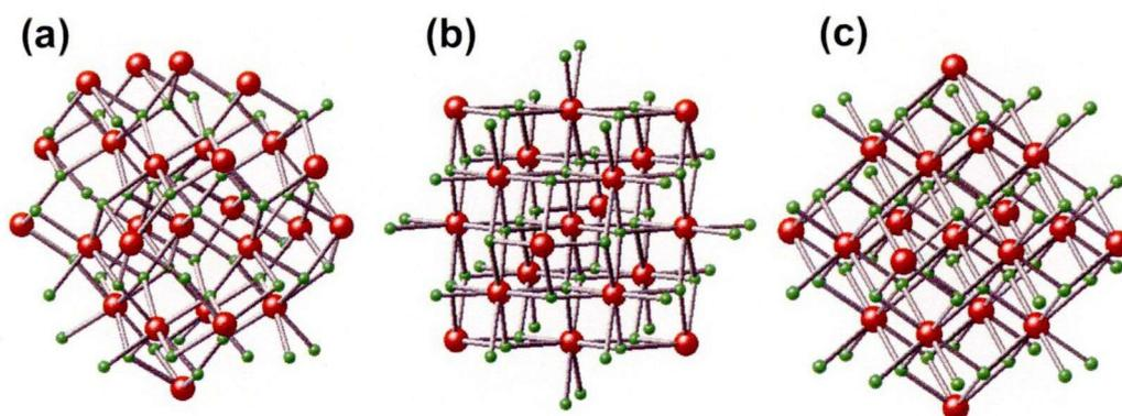
図 2.1 HfO<sub>2</sub> の結晶構造 (a: 単斜晶, b: 正方晶, c: 立方晶) .
