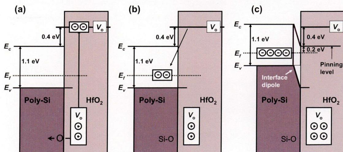
図 5.1 high- $k$  ゲートスタックのフェルミレベルピンニングに関する酸素空孔モデル; (a): HfO<sub>2</sub> 中から酸素原子が Poly-Si 中へ引き抜かれて酸素空孔(V<sub>o</sub>)が形成して余剰電子が生じる, (b): 余剰電子が Poly-Si 中に移動することでエネルギー利得が生じる, (c): HfO<sub>2</sub> と Poly-Si 界面にダイポールが形成してフェルミレベルが上昇する[3].
