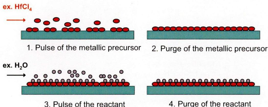
図 2.2 ALD プロセスの模式図 (原料: HfCl<sub>4</sub>, 酸化剤: H<sub>2</sub>O) .
