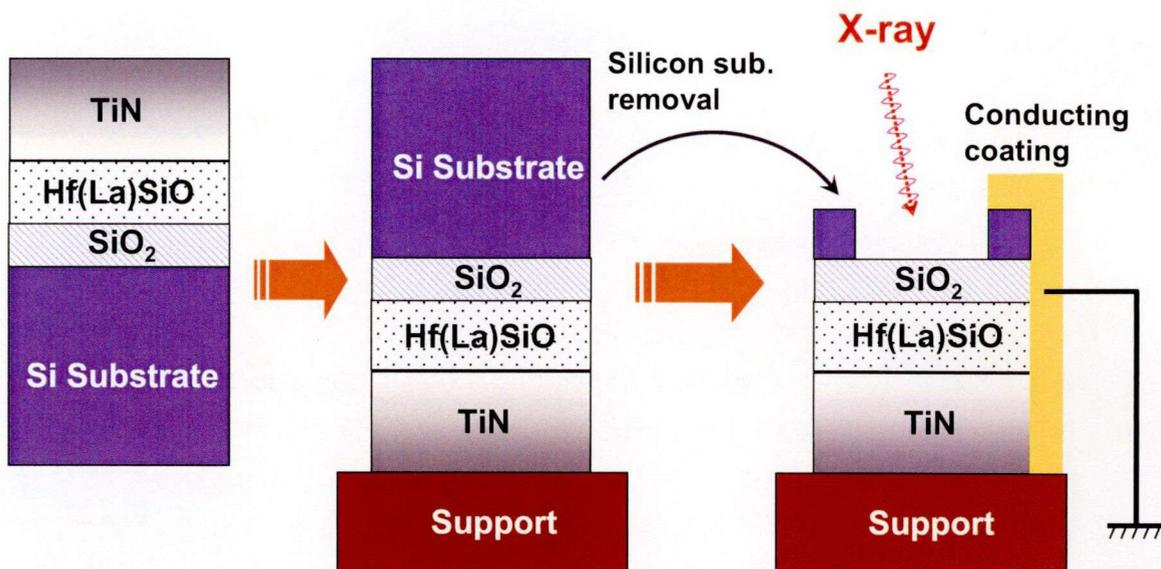
図 6.2 バックサイド加工の模式図.
