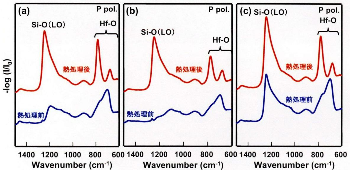
図 2.13 各試料の FT-IR ATR スペクトル; (a): 化学酸化膜付き Si 基板上的 HfO<sub>2</sub> 膜, (b): 酸化膜除去 Si 基板上的 HfO<sub>2</sub> 膜, (c): 熱酸化膜付き Si 基板上的 HfO<sub>2</sub> 膜.
