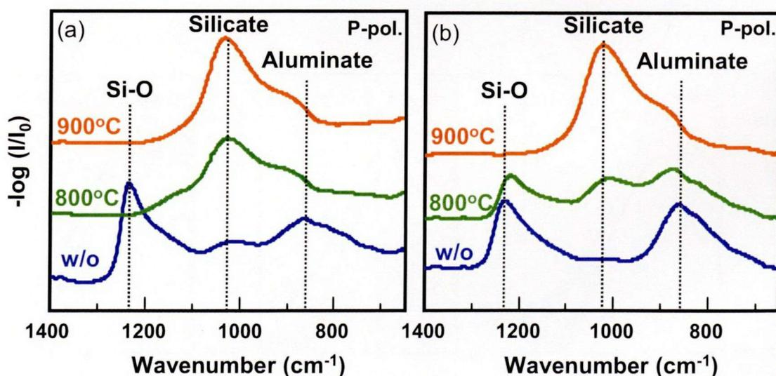
図 4.22 化学酸化膜と酸窒化膜上の YAIO 膜の熱処理による FT-IR ATR スペクトルの変化; (a): 化学酸化膜上, (b): 酸窒化膜上.
